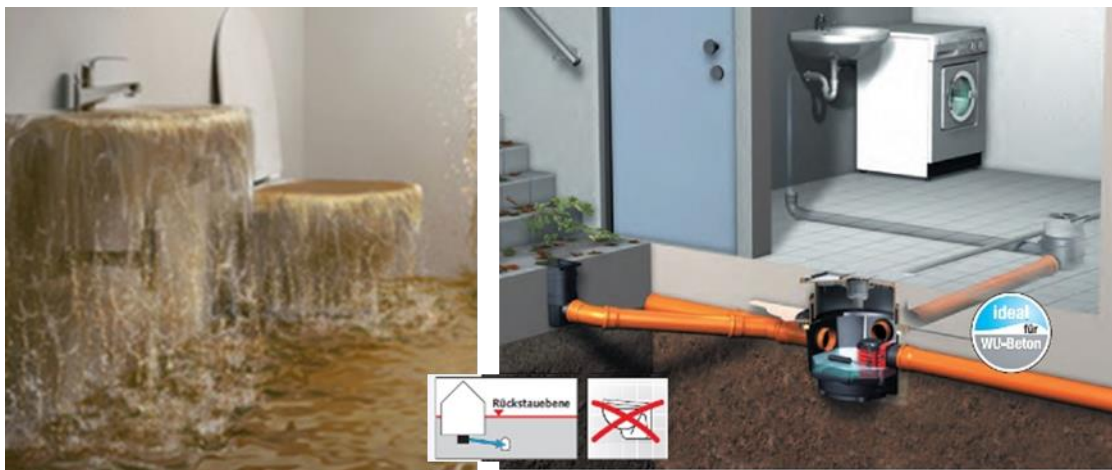
Abbildung 17: Risiko bei fehlender Rückstausicherung satzungsgemäße Hausinstallation
